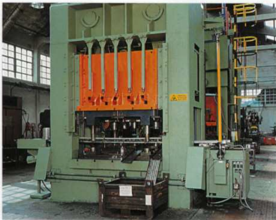
Sistema di trasferta meccanico a tre assi realizzato da Syndal.
