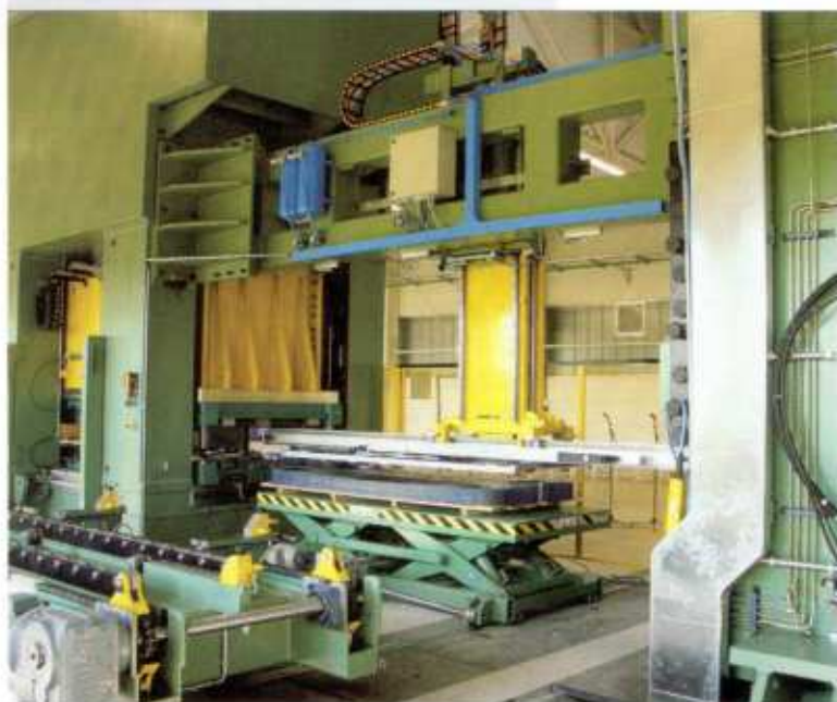
Il ciclo di lavoro del manipolatore HMF - HDL/3 corrisponde a una "U" rovesciata con sosta fuori dalla pressa per consentire lo stampaggio dei particolari.
