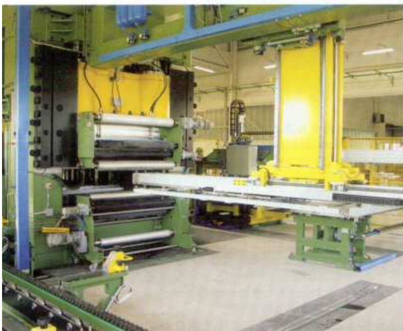
Il ciclo di lavoro del manipolatore HMF - HDL/3 corrisponde a una "U" rovesciata con sosta fuori dalla pressa per consentire lo stampaggio dei particolari.
